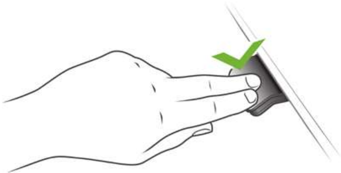
Abbildung 1: Drücken und halten Sie das DPG, um den Tisch nach oben zu fahren
