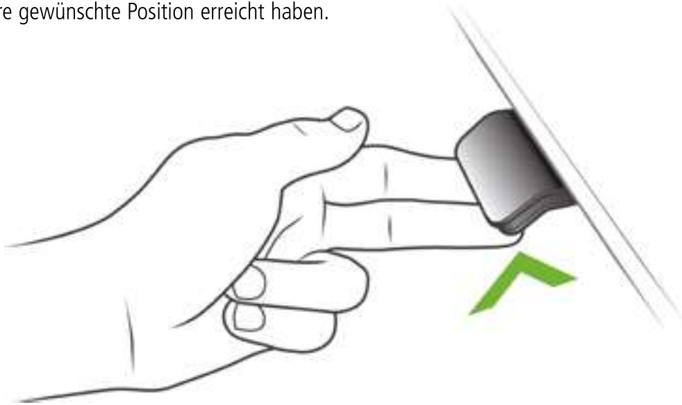
Abbildung 1: Drücken und halten Sie das DPG1K, um den Tisch nach oben zu fahren
