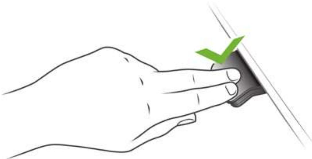
*Abbildung 2: Drücken und halten Sie das DPG, um den Tisch nach unten zu fahren*
