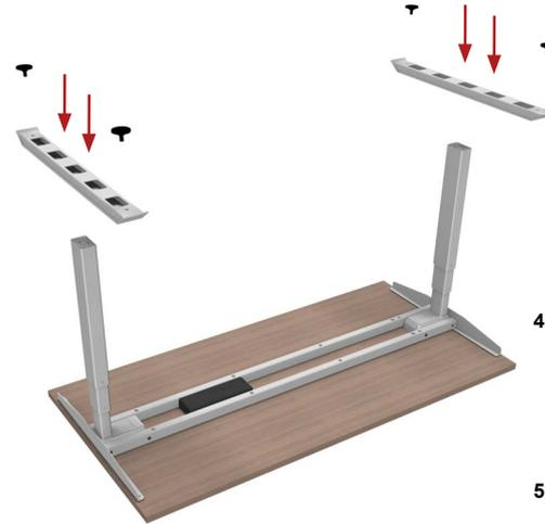
4. Setzen Sie die Kufen auf die Säulen und verschrauben Sie die Kufen mit den Inbusschrauben 6 x 16 mm.
