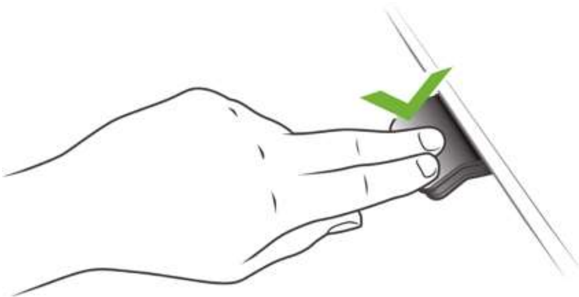
Abbildung 2: Drücken und halten Sie das DPG1K, um den Tisch nach unten zu fahren
